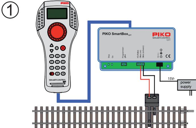
Schließen Sie **PIKO SmartControl<sub>light</sub>** Komponenten entsprechend der Aufbauskizze an und schalten sie die Betriebsspannung ein, indem Sie das Steckernetzteil in eine Steckdose stecken. Die grüne Kontroll-LED leuchtet und im **PIKO SmartController<sub>light</sub>** erscheint der Lokmodus.
